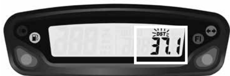
Fig 6 Función ajuste distancia
