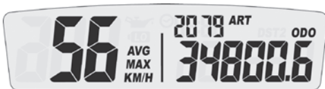
Pantalla 3 : Alterno velocidad AVG/MAX, Horas de funcionamiento, ODO
