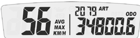
Display 3: Wechsel der Geschwindigkeit AVG/MAX, Betriebsstunde, ODO
