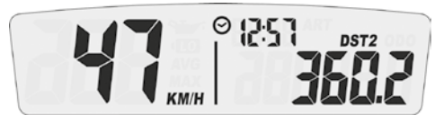
Display 2: Geschwindigkeit, Uhrzeit, DST2
