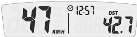
Display 1: Geschwindigkeit, Uhrzeit, DST 1
