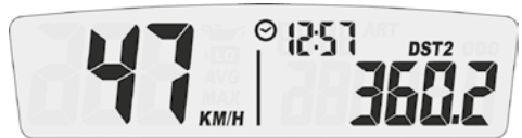
Display 2: Geschwindigkeit, Uhrzeit, DST2
