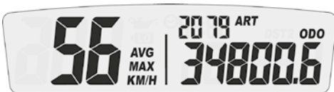
Display 3: Wechsel der Geschwindigkeit AVG/MAX, Betriebsstunde, ODO
